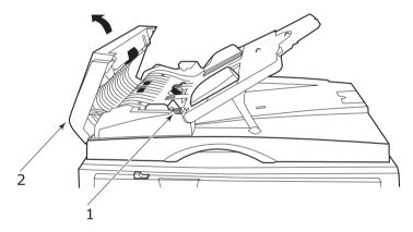
**2.** Нажмите двумя пальцами на оба плечика блока прокладки ADF и достаньте его.
