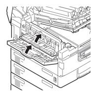
**10.** Верните на место корзину печатных барабанов (9) и проверьте надежность ее закрепления.
