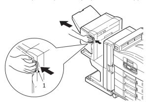
**2.** Поверните утопленную ручку (2) и откройте левую боковую крышку инвертора.
