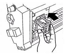
**11.** Убедитесь в том, что он надежно закреплен в устройстве для скрепления бумаги и верните устройство на место.
