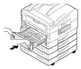
**10.** Если для получения доступа к устройству двусторонней печати вы отсоединили финишер, то верните на место и его.
