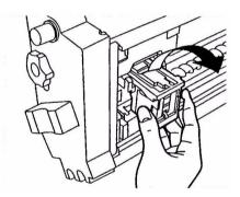
7. Поднимите затвор картриджа устройства скрепления.
