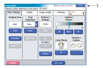
Кнопка Status (1) меняет цвет в зависимости от состояния многофункционального периферийного устройства:
