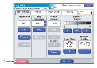
**1.** Закончив работу со сканером, нажмите кнопку Logout (1), чтобы вернуться к экрану контроля доступа.
