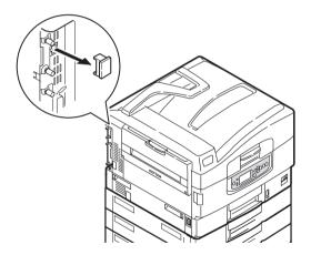
**3.** Подключите принтер к концентратору Ethernet при помощи сетевого кабеля Ethernet. Убедитесь, что ферритовый сердечник сетевого кабеля находится рядом с интерфейсом принтера.
