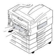
**4.** Выдвиньте устройство двусторонней печати при помощи ручек (3).
