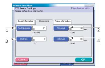
(b) Вкладка Extensions (Расширения): Port Number (Номер порта) (1), Timeout (Тайм-аут) (2), Retries (Повторы) (3), Interval (Интервал) (4).
