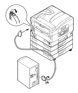
3. Включите принтер, а затем компьютер.
