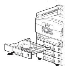
**4.** Протрите 3 валика подачи бумаги (2) через зазор, оставшийся после удаления лотка 1. Используйте мягкую ткань, слегка смоченную водой.
