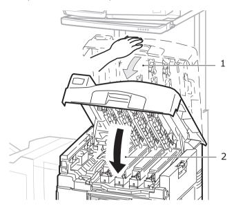
**4.** Поверните рычаг стойки сканера (1) и опустите сканер вниз до упора. Убедитесь, что стойка закреплена в данной позиции.
